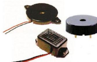
Les buzzers transforment l'énergie électrique en énergie mécanique et vibrent, ils produisent alors un son.
